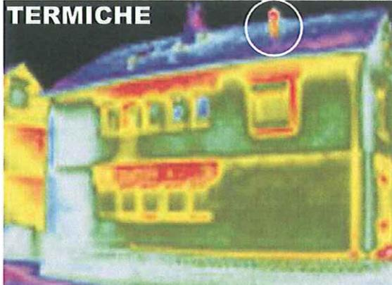
L'installazione della valvola di aerazione **MAXI-VENT** evita il foro nel tetto salvaguardando l'isolamento termico.
